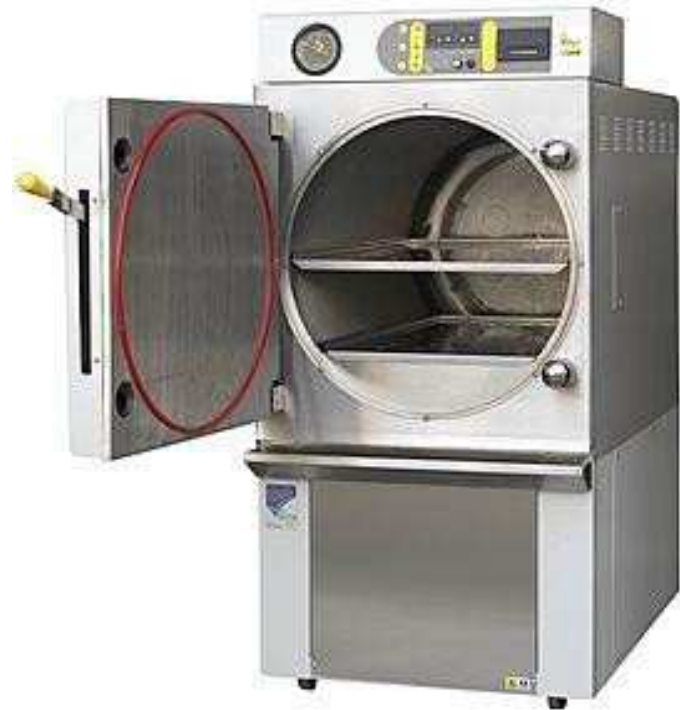
Autoclave/stérilisateur = Appareil à couvercle amovible à fermeture rapide (ACAFR)
